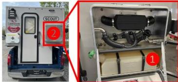
Le camping-car est équipé d'un chauffage diesel économe en énergie. Le réservoir de gasoil ① est monté à l'extérieur ② du camping-car. Pour allumer le chauffage, appuyez sur HEATING MODE ③ sur le CONTRÔLEUR DE FOURNAISE ④ à l'intérieur du camping-car. Cela vous mènera à l'ÉCRAN DU THERMOSTAT ①. Ici, il suffit d'utiliser votre doigt pour régler la température ④.
