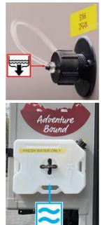
d'arrosage. Utilisez le bouchon du réservoir d'eau ① comme pompe mécanique pour faire passer l'eau à travers la tête de pulvérisation ③. Un réservoir d'eau de rechange ≈ est fixé à l'extérieur du camping-car.
