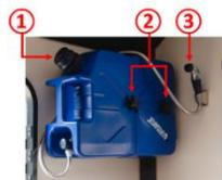
Le SCOUT OLYMPIC est livré avec un système d'eau alimenté par gravité avec drainage extérieur.
