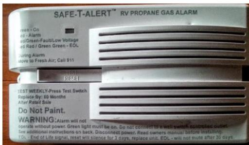
Chaque VR est équipé d'un détecteur de propane, situé près du sol. L'alarme se déclenche chaque fois qu'une augmentation des émissions de propane (par exemple, de la cuisinière ou du four) est détectée. Assurez-vous de ne pas placer d'objets sur le détecteur de propane pour éviter les fausses alarmes.
